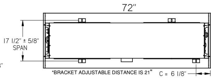
\*LENGTH C IS MINIMUM DISTANCE FROM BRACKET SLOT TO BEAM END.
